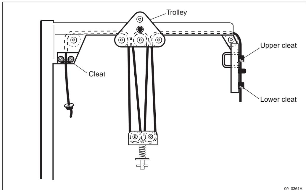
Figure 197 Rope wiring
